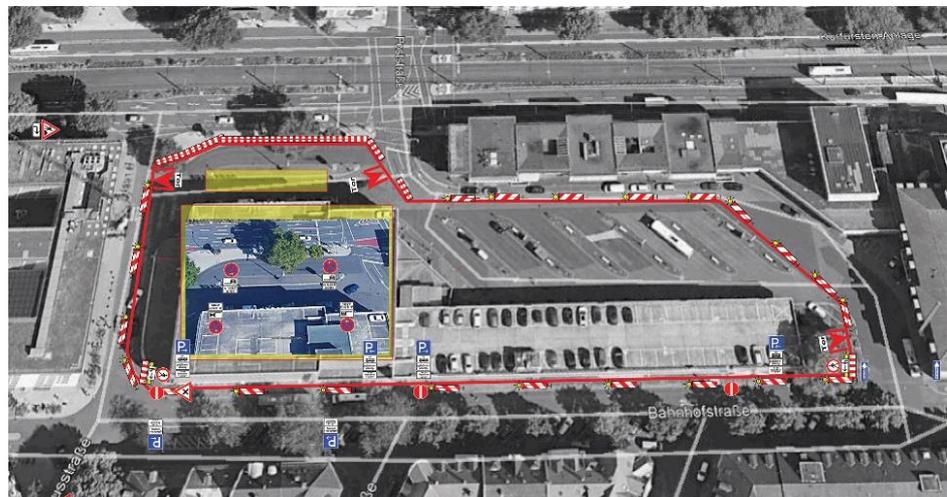
Bereits begonnen hat die Einhausung der Baustelle für den ersten Bauabschnitt mit einem Bauzaun. Dessen Holzbauweise sorgt für eine zusätzliche Reduktion der vom Abbruch und der Baustelle insgesamt ausgehenden Geräusche.
