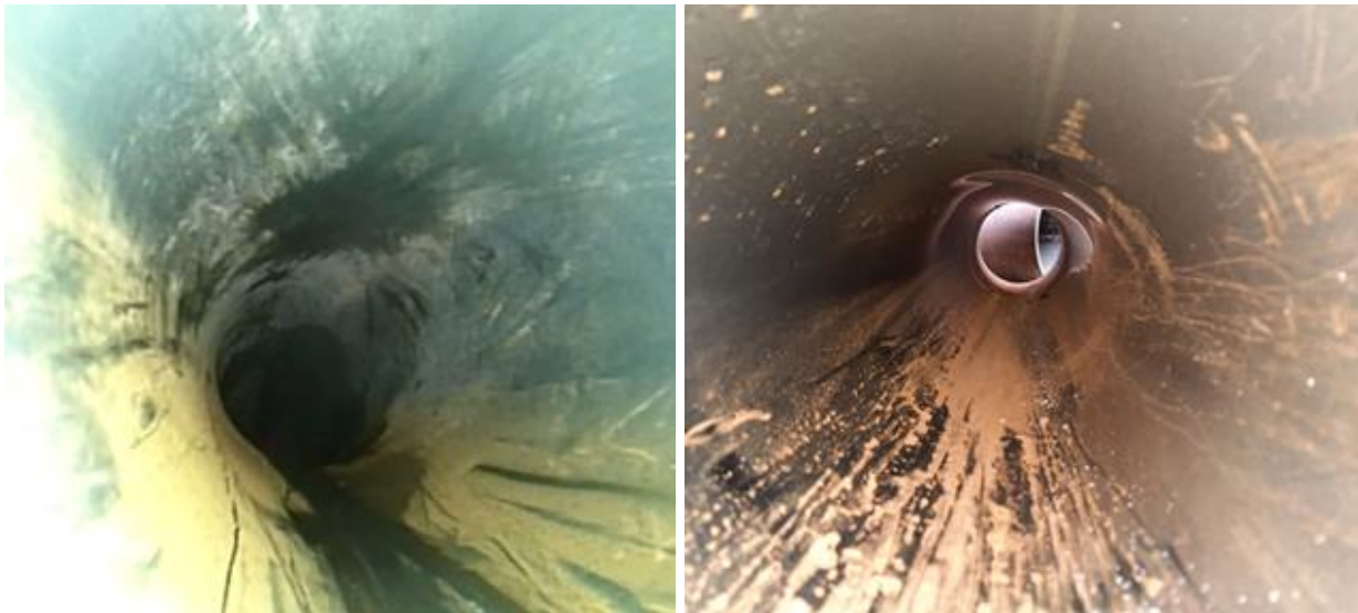
Bild 22 Optischer Gesamteindruck: Compact Pipe ohne Auffälligkeiten (links), egeLiner ohne Auffälligkeiten (rechts)
