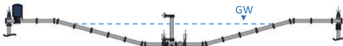
Bild 12 Wasserstand bei Infiltrationsprüfung
