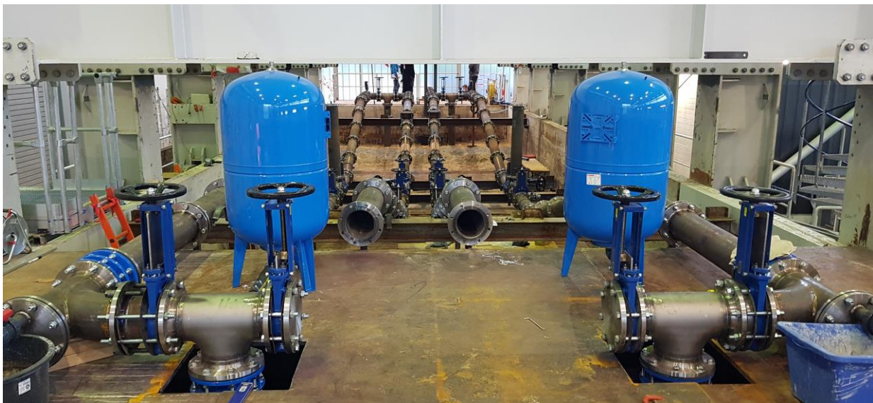
Bild 9 Aufbau für Leistungsbewertungsprüfung Nullmessung mit Stahlleitungen ohne Schadensbilder: Für Pumpe 1 (durchgehender Leitungsstrang linke Versuchsstandsseite) und Pumpe 2 (durchgehender Leitungsstrang rechte Versuchsstandsseite)
